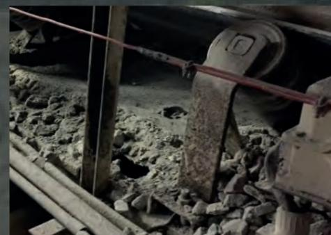
**Загрязнение** из-за плохого уплотнения мест перегрузки материала
