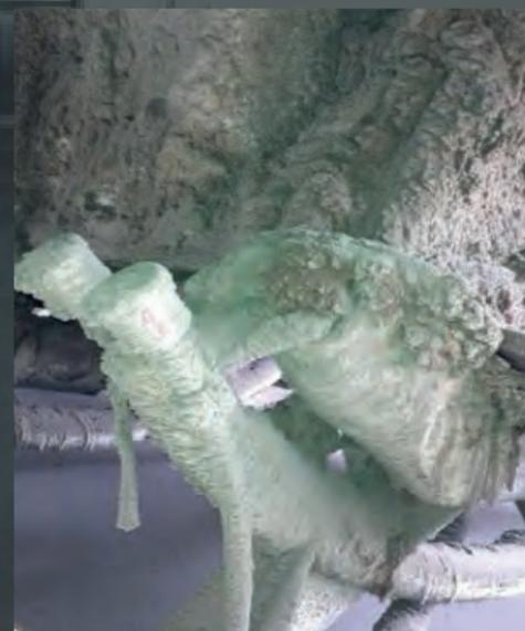
Агрессивная **пыль**, налипающая и скапливающаяся на деталях
