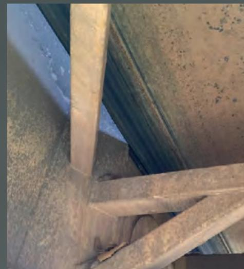
**Сход ленты конвейера:** Конвейерная лента уже врезается в несущую конструкцию
