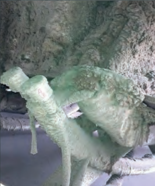
Poussière agressive qui se fixe et s'accumule sur les composants
