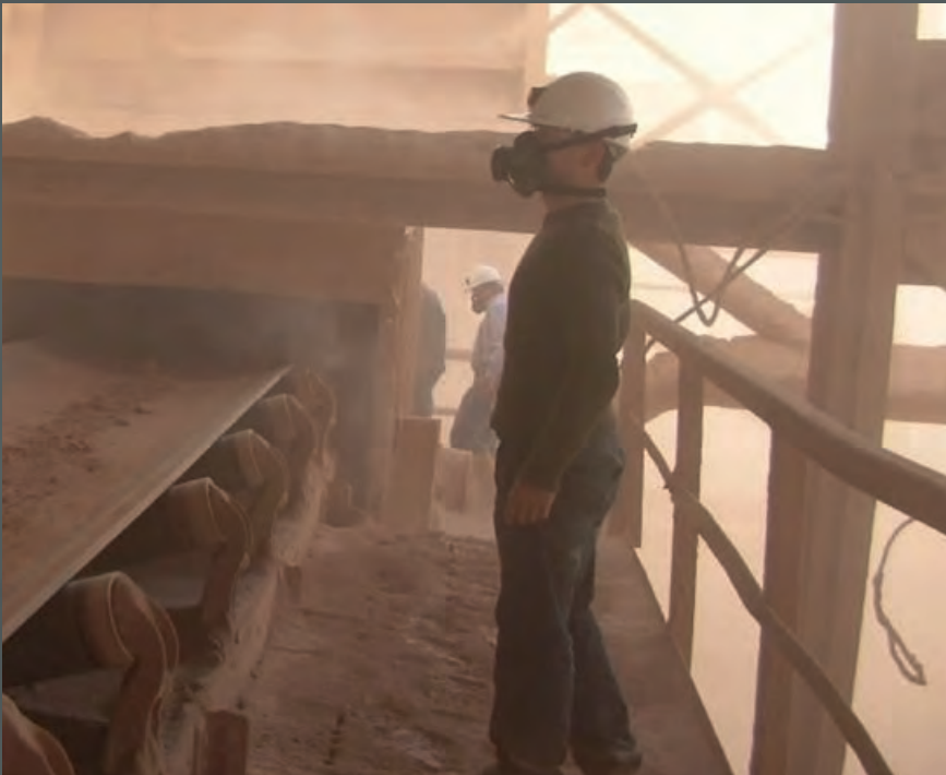
Volume de poussière élevé, boîtier nécessaire
