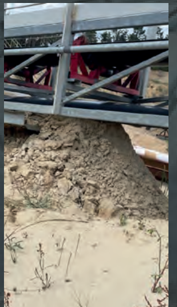
Montículos de material residual debajo de la banda
