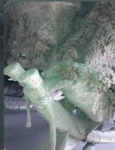
Aggressiver **Staub**, der sich an Bauteilen festsetzt und aufbaut
